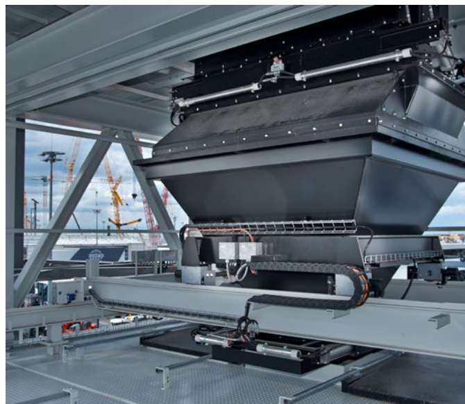
Benne navette encapsulée pour réduire les émissions de poussière et de fumée.
