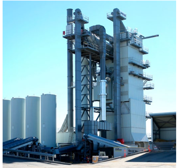
Le poste d'enrobage Universal HRT dispose d'un système d'aspiration des vapeurs vertical.
