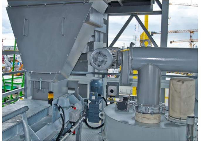
Optimisation des processus : ajout de recyclés à froid directement dans le malaxeur via une bascule à recyclés.
